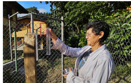
Einfache Wasserstation mit Niederschlagsmesser, die von Personen, die im Projekt fachlich geschult werden, bedient wird.
